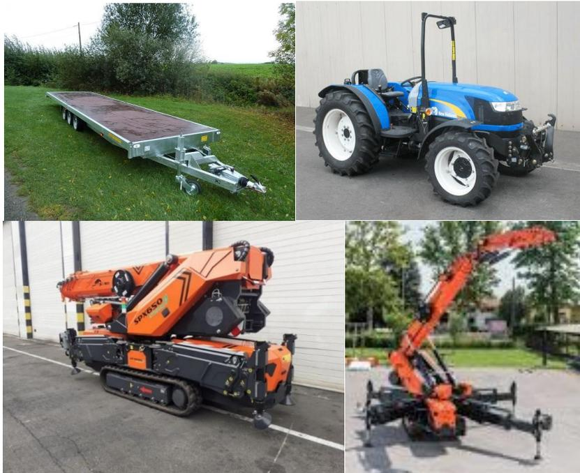
Photo 1 : Type d'engins utilisés (Plateau, tracteur, grue araignée à chenilles souples)(Source : MCF)
