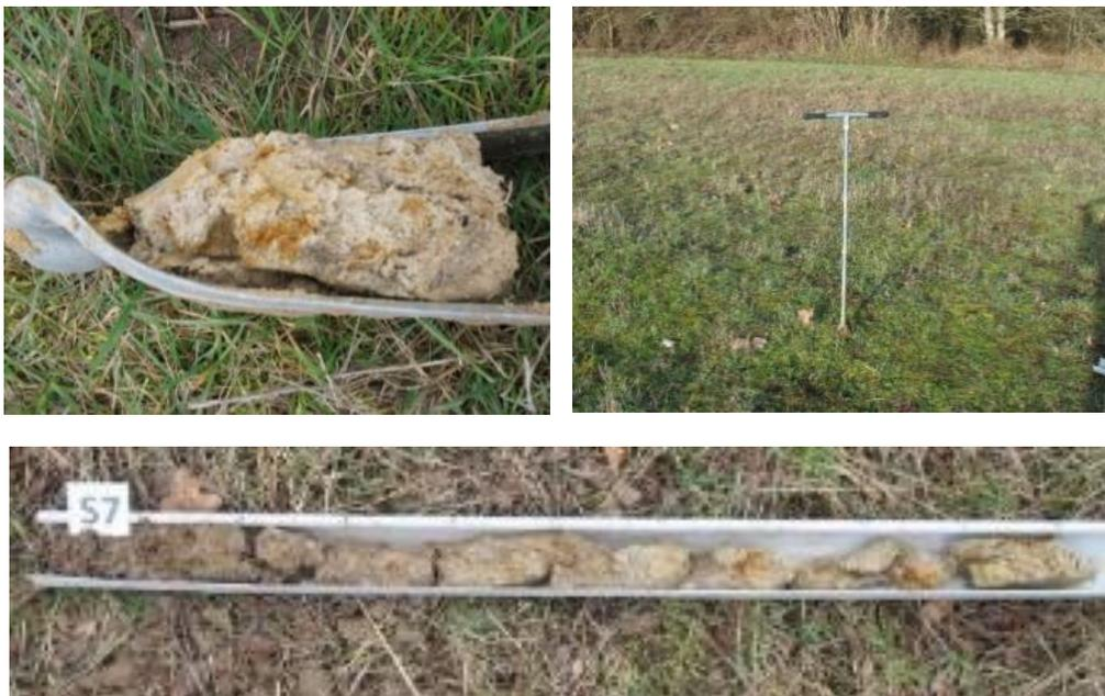
Photo 5 : Sondage pédologique à la tarière et vue d'un carottage (Source : CDPNE)
