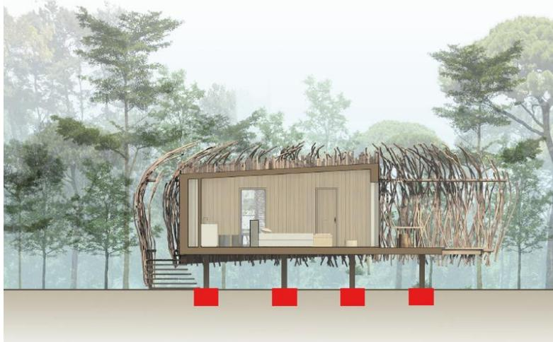
Figure 9. Cabanes type sur pilotis (prévisionnel conception pour le projet de Dhuizon)
