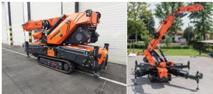
Photo 74 : Type d'engins utilisés (Plateau, tracteur, grue araignée à chenilles souples)(Source : MCF)
