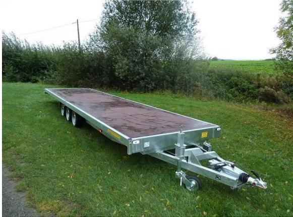
Plateau avec bande de roulement réduite largeur 1,6m
