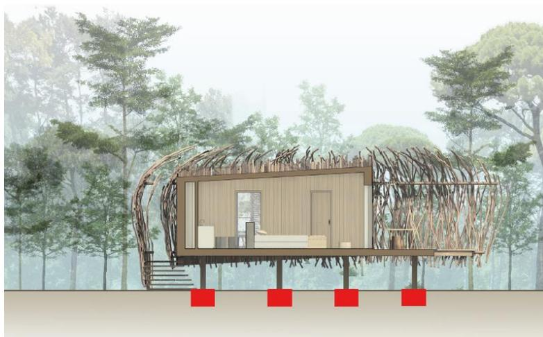
Figure 11. Cabanes type sur pilotis (prévisionnel conception pour le projet de Dhuizon)
